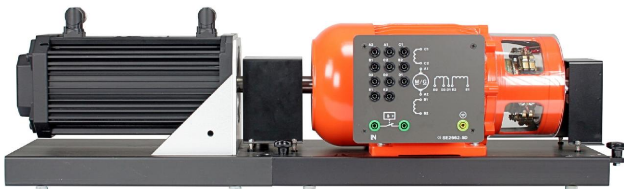
Рисунок 7.9 – Испытательный стенд серво-двигателя (слева), соединенный с многофункциональной машиной постоянного тока (справа)
