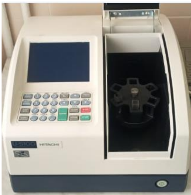
Рисунок 5.1 – Внешний вид прибора Hitachi U-5100 UV/Vis
