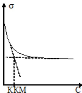
Рис. 10.1. Графическое определение ККМ по изменению поверхностного натяжения
