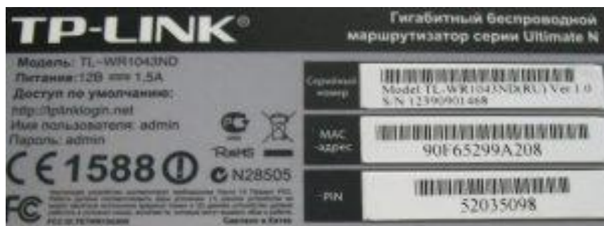
Рисунок 9.6 - На этикетке маршрутизатора читаем PIN-код
