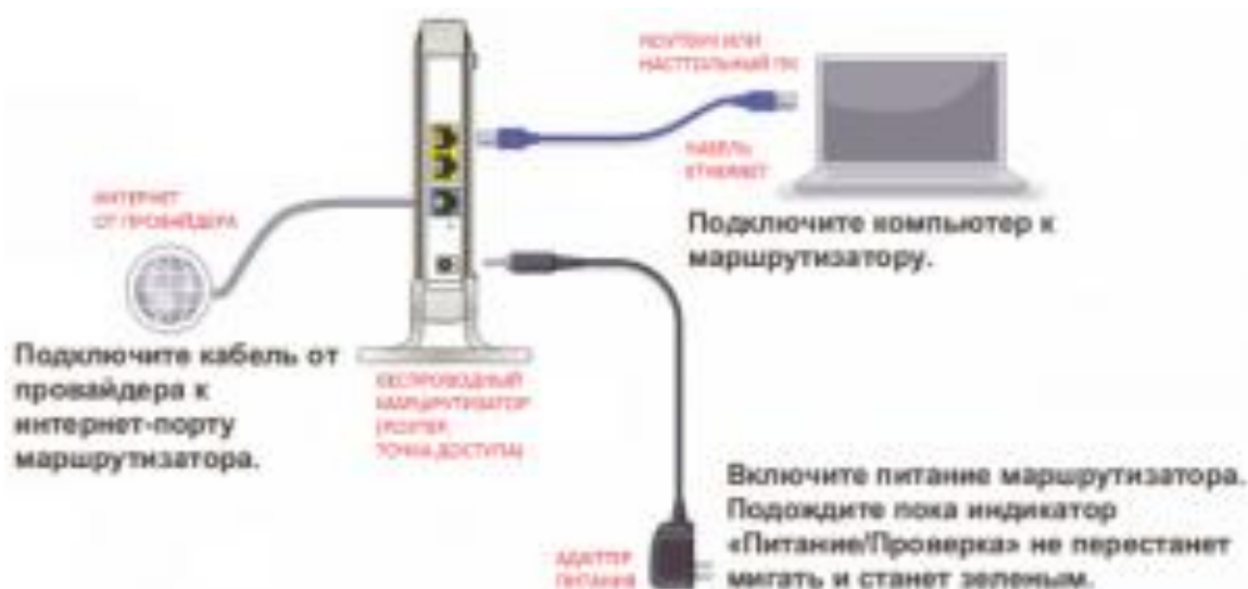
Рисунок 9.13 - Схема подключения устройств беспроводной сети к точке доступа
