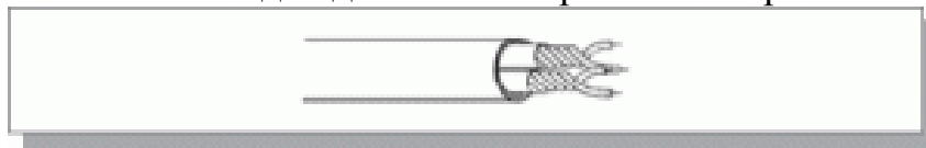
Рисунок 15.5 – Кабель с витыми парами
