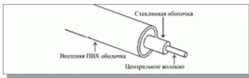
Рисунок 15.7 – Структура оптоволоконного кабеля
