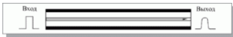
Рисунок 12.8 – Распространение света в одномодовом кабеле
