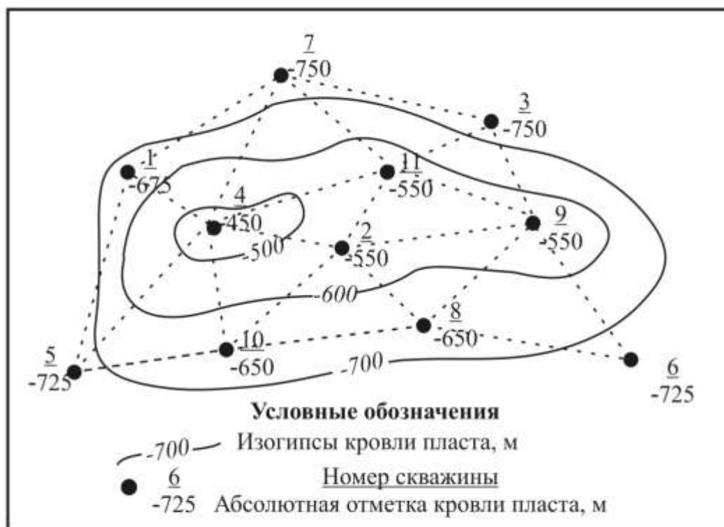
Рисунок 4.2 Построение структурной карты методом треугольников (по М.А. Жданову)
