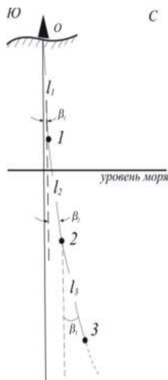
Рисунок 2.2 Построение вертикальной проекции скважины упрощённым способом
