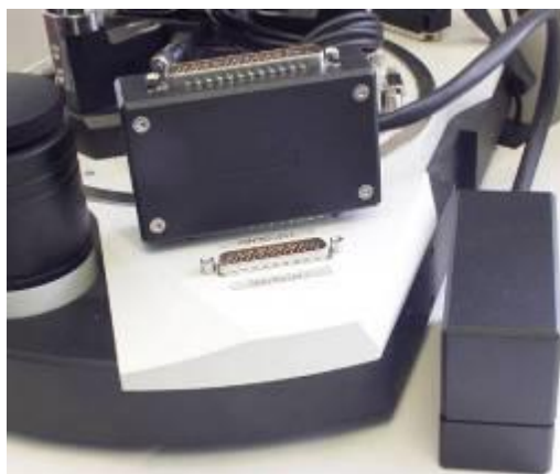
Рисунок 5 – Расположение разъема CONTROLLER 2 на базовом блоке прибора
