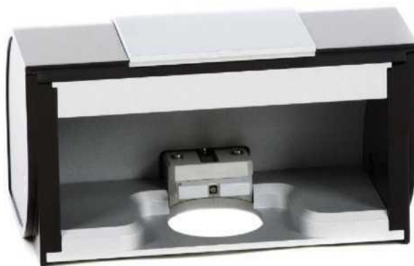
Рисунок 7 – Измерительная головка с установленным вкладышем
