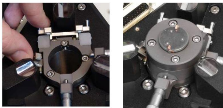
Рисунок 4 – Установка держателя образца
