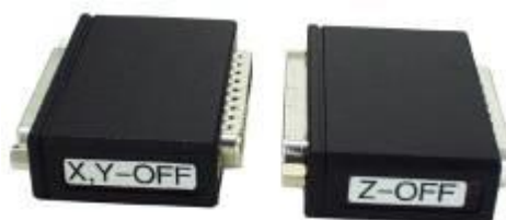
Рисунок 7 – Адаптеры для отключения сканирования по осям XY и Z
