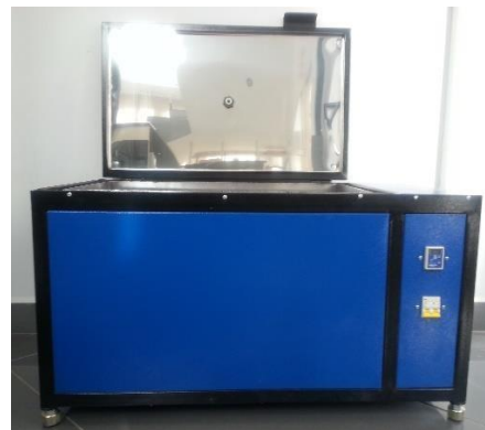
Рисунок 5.5 – Бачок для кипячения образцов
