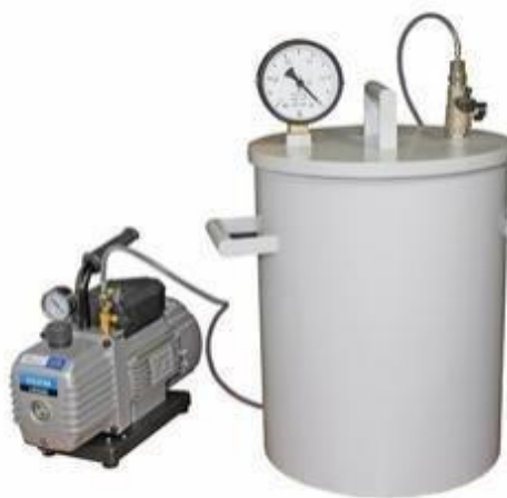
Рисунок 2 – Вакуумная установка ву-976а для водонасыщения образцов
