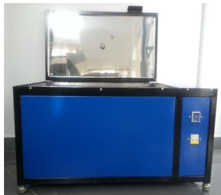
Рисунок 5.5 – Бачок для кипячения образцов
