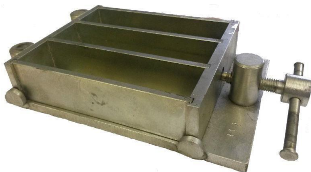
Рисунок 6.3 – Трехгнездовая форма для изготовления образцов-балочек размером 4 \times 4 \times 16 см
