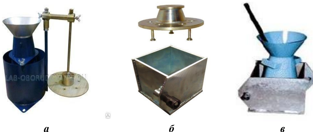
Рисунок 8.3 – Определение жесткости бетонной смеси: а – прибор Вебе; б – прибор Красного; в – прибор Скрамтаева
