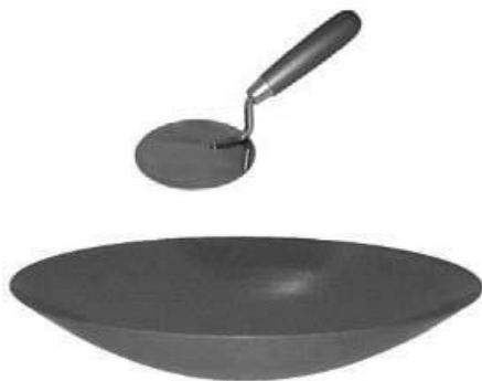
Рисунок 5.1 – Чаша и лопатка для затворения цемента
