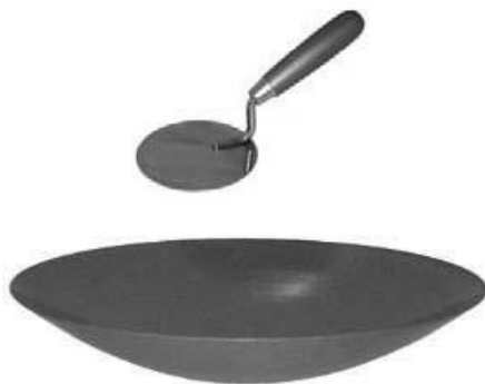
Рисунок 5.1 – Чаша и лопатка для затворения цемента
