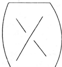
Рисунок 2.2 – Схема образования трещин чугунного образца
