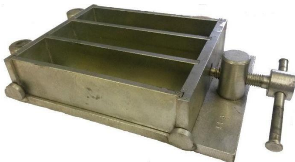
Рисунок 6.3 – Трехгнездовая форма для изготовления образцов-балочек размером 4×4×16 см
