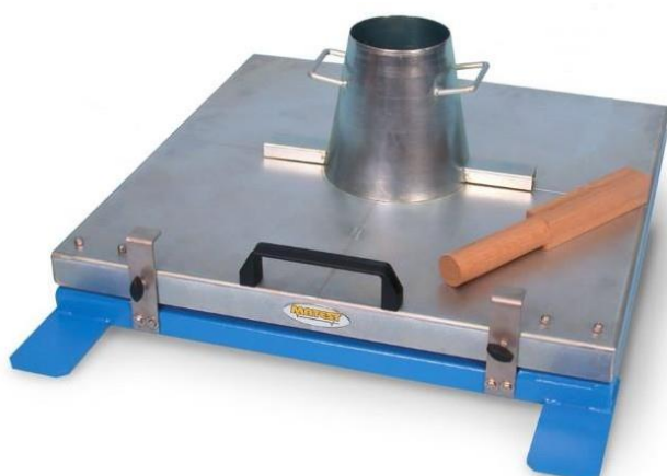
Рисунок 8.4 – Прибор для определения растекаемости бетонной смеси а – внешний вид прибора; б – схема конуса и уплотняющего бруса:
