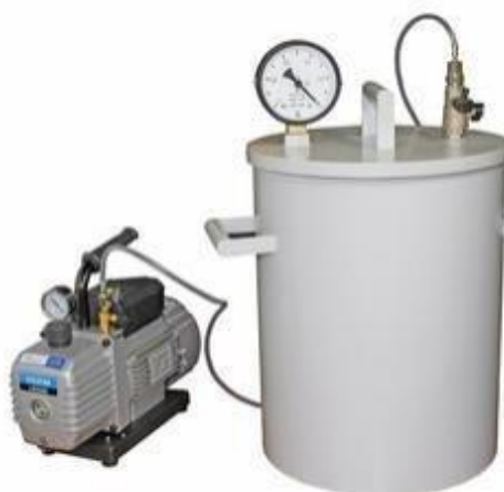
Рисунок 2 – Вакуумная установка ву-976а для водонасыщения образцов
