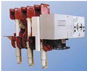
Рисунок 2.8.8 - Разъединитель РТ, имеющий трехполюсную конструкцию с общим приводом. Трехпозиционная конструкция позволяет перевести аппарат в положение «заземлено» только из положения «отключено»
