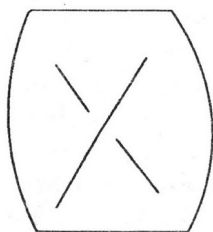
Рисунок 2.2 – Схема образования трещин чугунного образца
