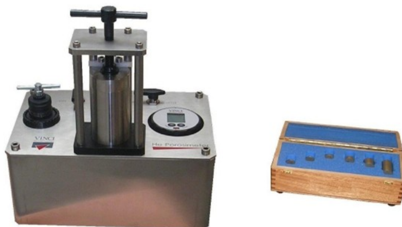
Рисунок 6.2 – Общий вид прибора для измерения пористости
