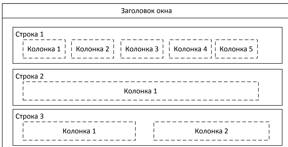
Рисунок 6.2 – Сетка размещения элементов управления в PySimpleGUI
