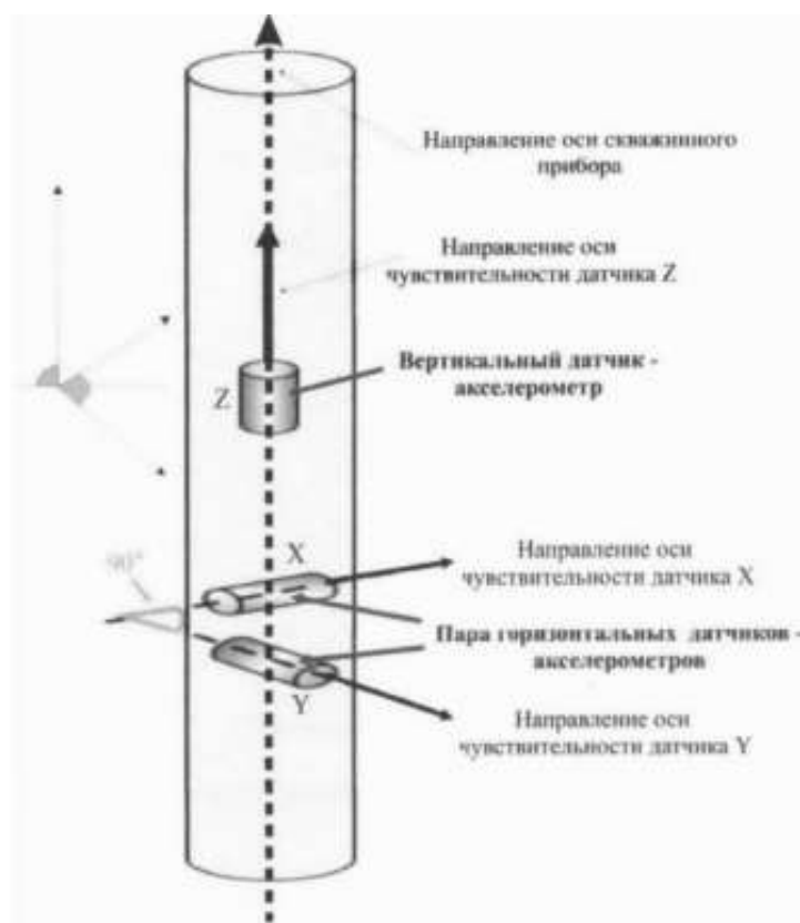
Рисунок 13.3 - Схема прибора трехкомпонентного геоакустического каротажа
