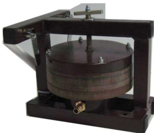
Рисунок 3.6— Рабочая часть установки по исследованию материалов на теплопроводность методом «пластины»
