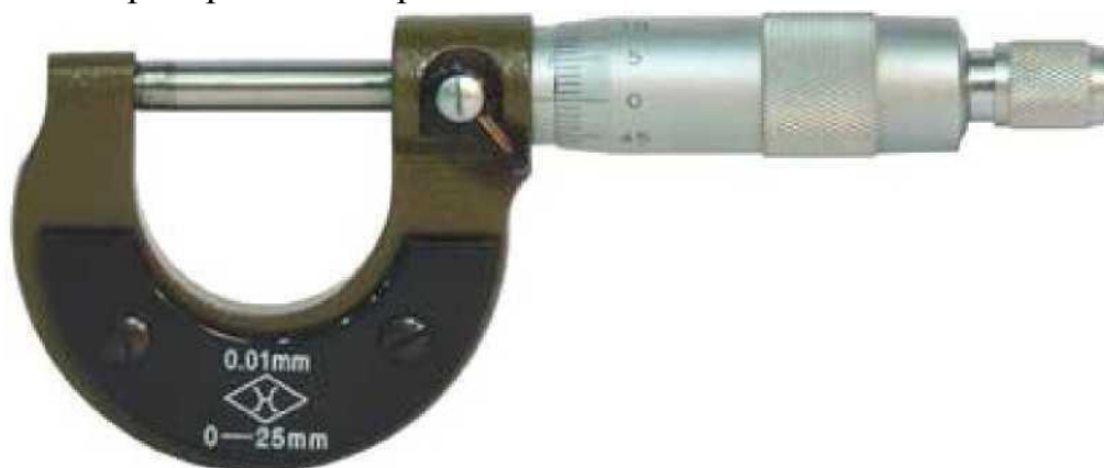
Рис. 3. Контроль установки гладкого микрометра на «ноль»
