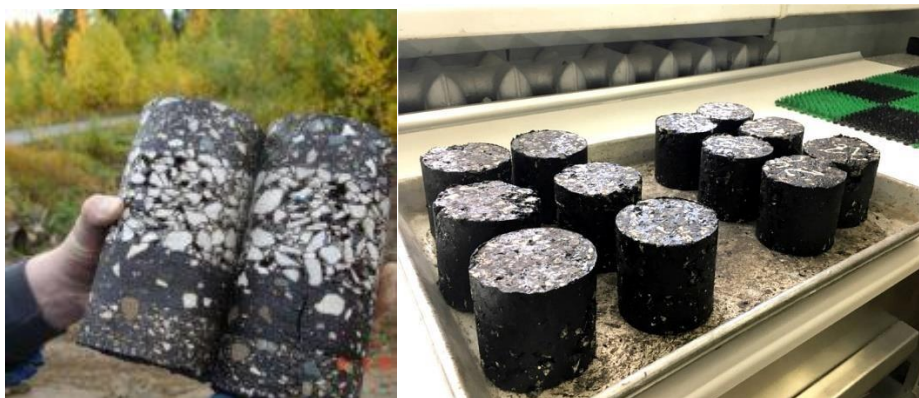
Рисунок 1 – Образцы керны и переформованные-образцы
