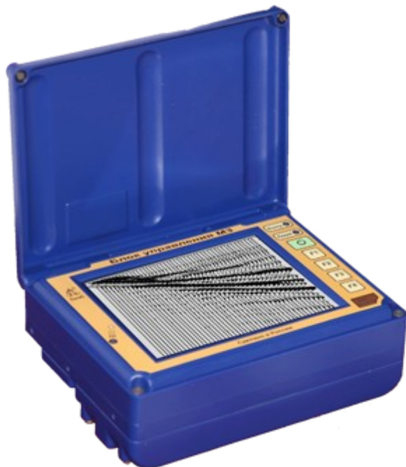
Рисунок 1.6 Блок-индикации сейсмостанции Лакколит
