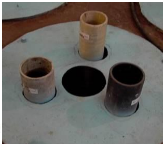
Рисунок 4 – Схема и фото комплекта трубных волноводов для калибровки аппаратуры АК
