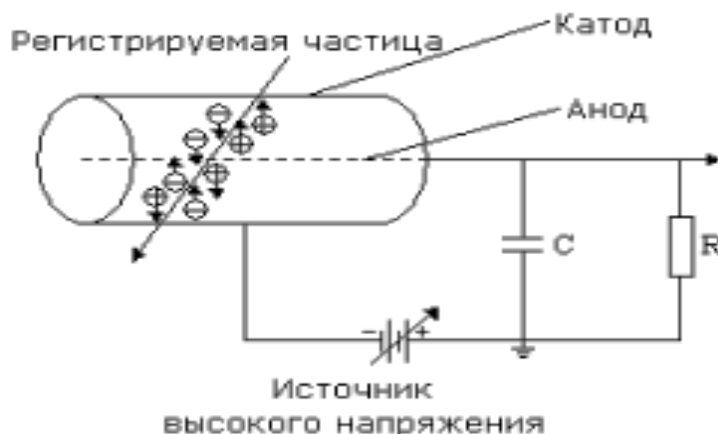
Рисунок 2. 4 – Принципиальная схема конструкции ГС
