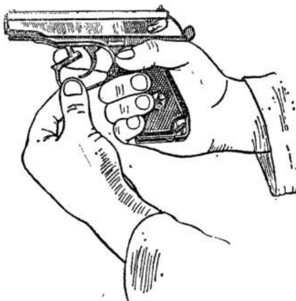
Рис. 4. Оттягивание спусковой скобы
