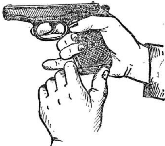
Рис. 3. Извлечение магазина из основания рукоятки
