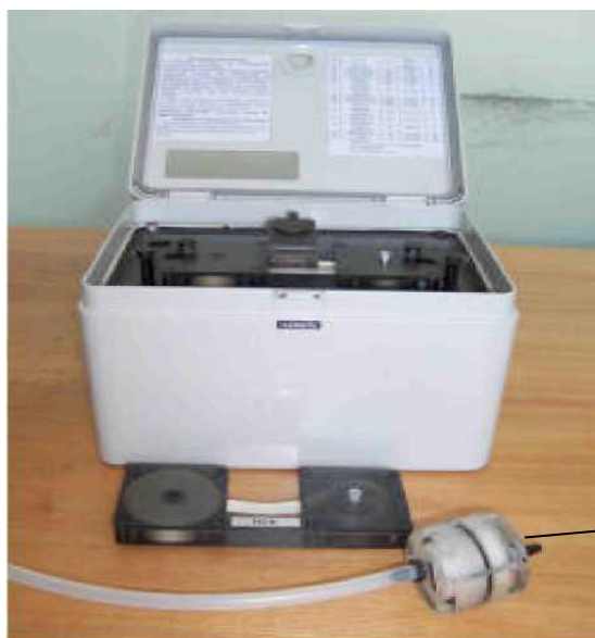
Рисунок 3.2 – Общий вид газоанализатора ГАНК-4
