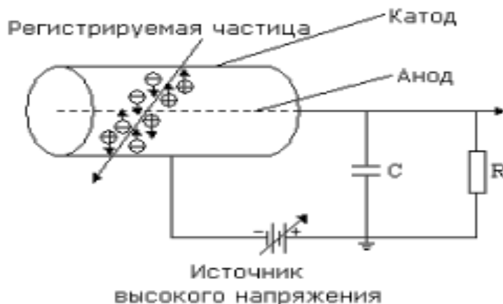
Рисунок 2. 4 – Принципиальная схема конструкции ГС
