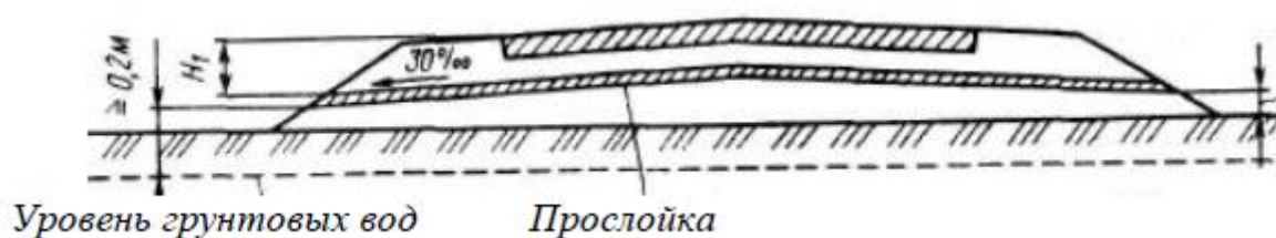
Рисунок 10.7 – Конструкция влагоизолирующей прослойки
