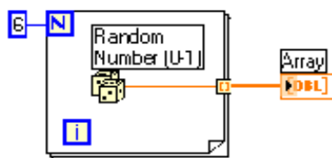
Рисунок 3.3 – Пример создания одномерного массива.
