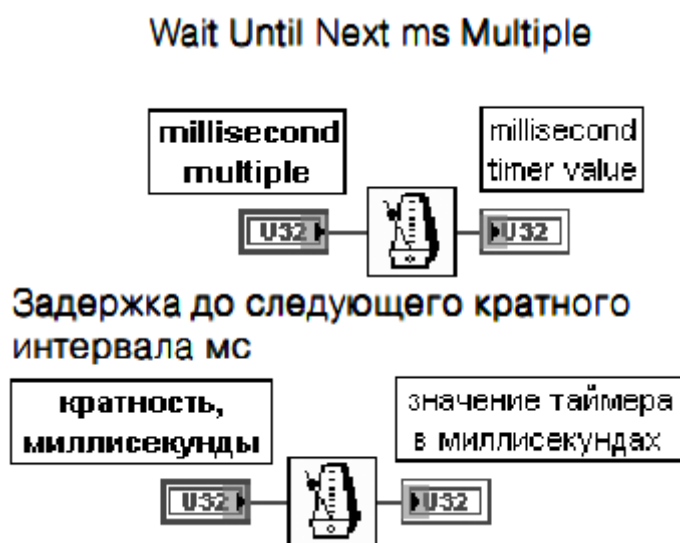
Рисунок 8.5 – Функция Задержка до следующего кратного интервала
