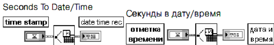
Рисунок 8.7 – Функция преобразует значение времени
