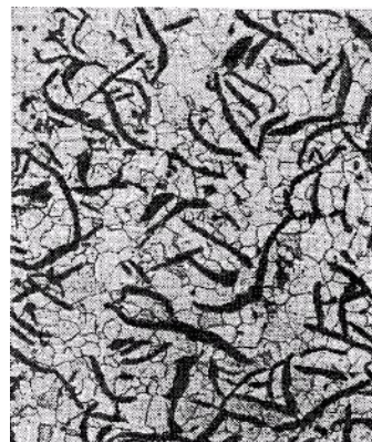
Рисунок 6. Микроструктура серого чугуна с ферритной металлической основой. X 200
