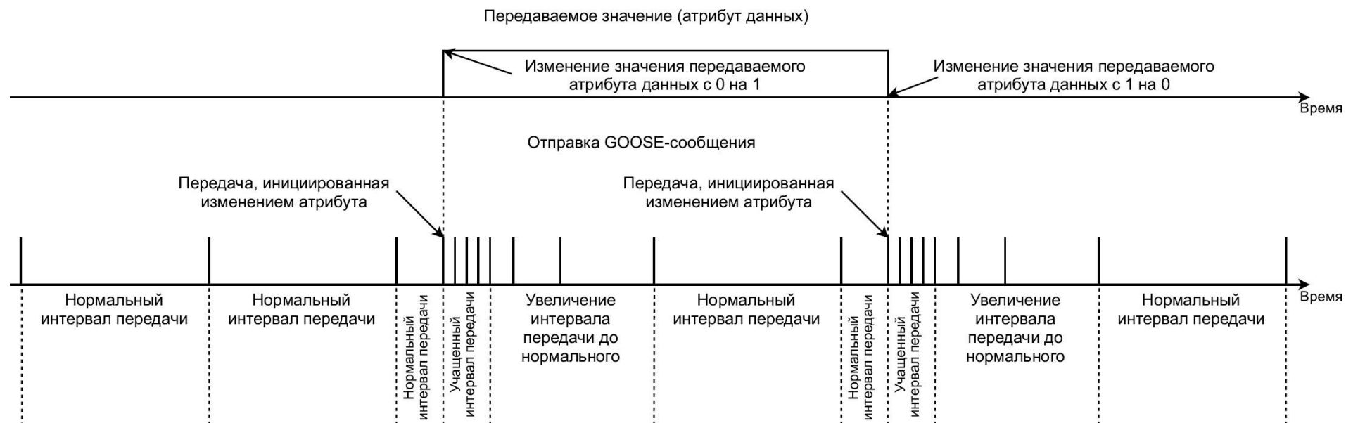
Рисунок 1.5 – Передача GOOSE-сообщений при изменении данных
