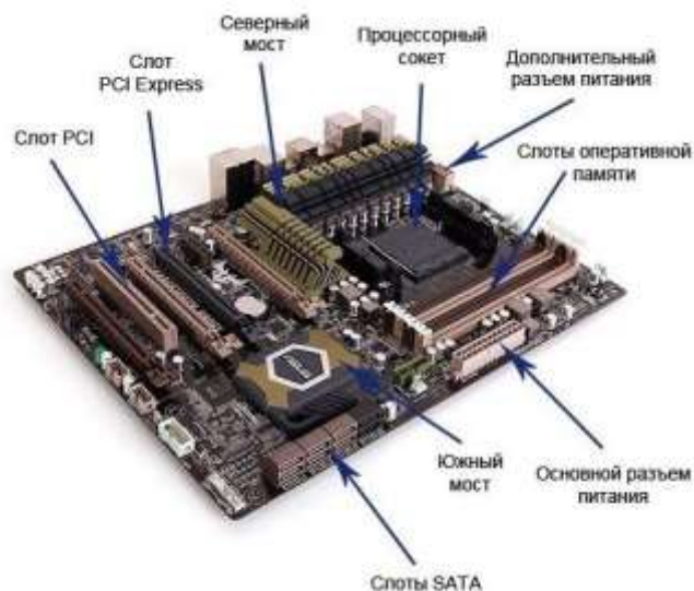
Рисунок 31.1 - Базовые компоненты материнской платы
