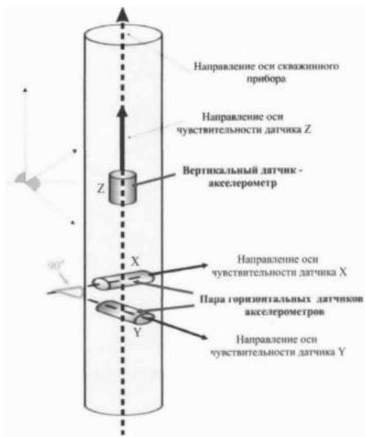
Рисунок 13.3 - Схема прибора трехкомпонентного геоакустического каротажа
