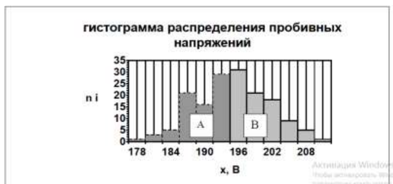
Рисунок Гистограмма распределения пробивных напряжений Таблица 10 Справочно: расчет средней и дисперсии исполнителя А
