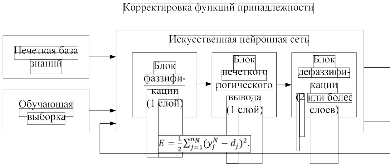
Рис. 4.1. Общая структура гибридной нейро-нечеткой системы
