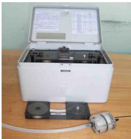
Рисунок 3.2 – Общий вид газоанализатора ГАНК-4
