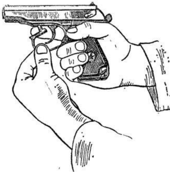
Рис. 4. Оттягивание спусковой скобы
