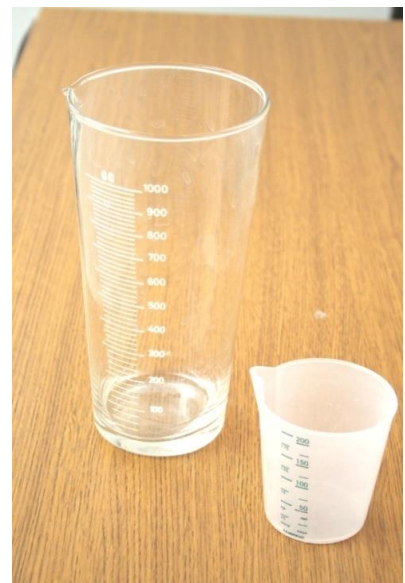
Рисунок 5. Мерные цилиндры (а) и мензурки (б)
