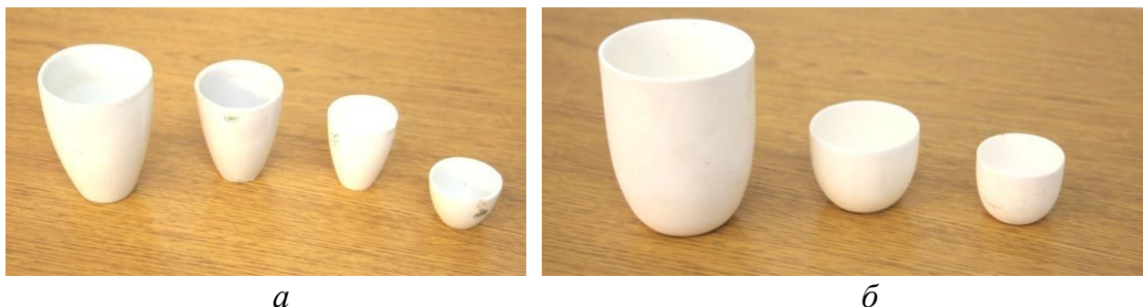
Рисунок 13. Тигли из фарфора (а) и алунда (б)
