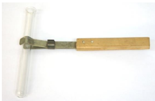
Рисунок 2. Держатель для пробирок.
