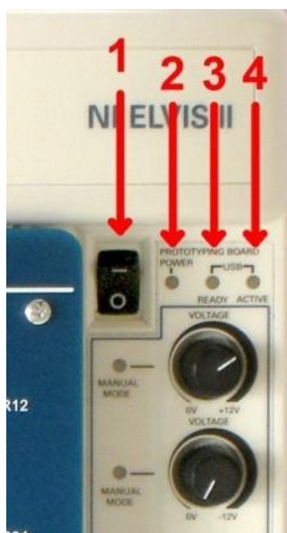
Рисунок 1.12 – Выключатель питания платы и индикаторы
