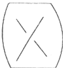
Рисунок 2.2 – Схема образования трещин чугунного образца
