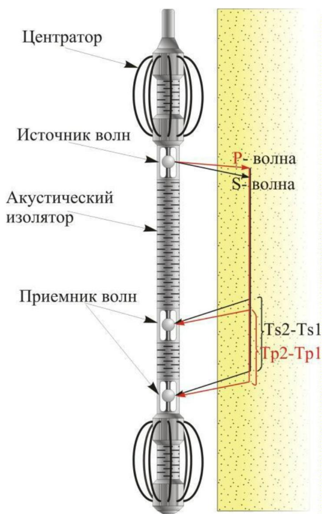
Рисунок - 1 Схема устройства и работы скважинного прибора АК
