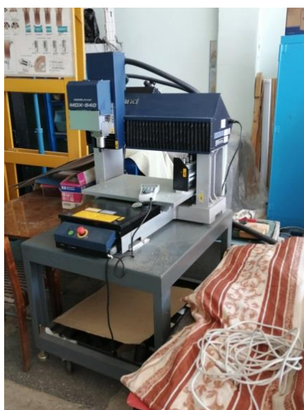
Рисунок 5 - Фрезерный станок с ЧПУ ROLAND -MDX-540.
