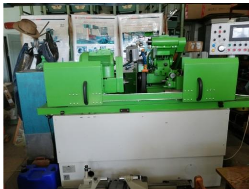
Рисунок 9 - Круглошлифовальный универсальный станок модель-3У12РА
