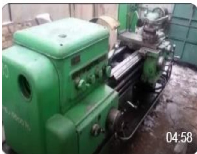
Рисунок 1 - Токарно-винторезный станок мод 1К62.
