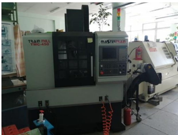
Рисунок 4 - Обрабатывающий центр с ЧПУ модели ТМС-450
