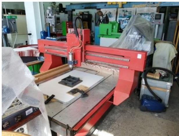
Рисунок 4 - Фрезерный станок с ЧПУ Роутер 1216.
