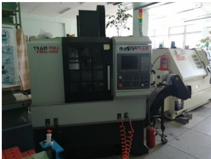
Рисунок 1 - Обрабатывающий центр с ЧПУ модели TMC-450
