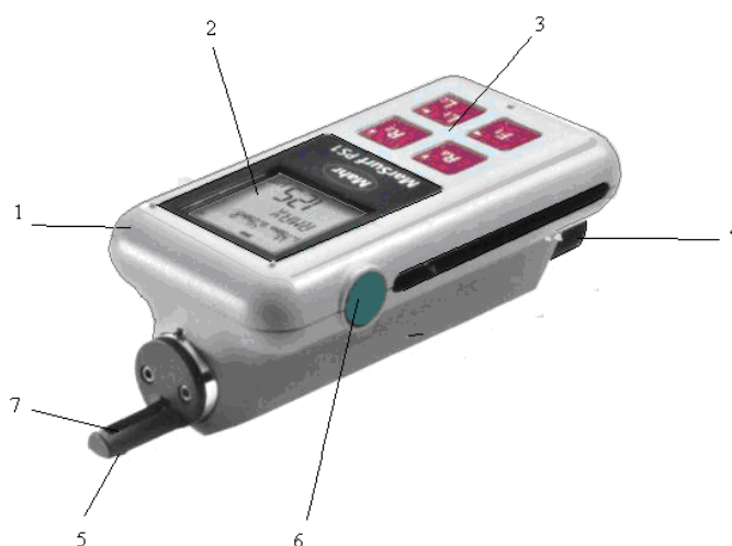
Рисунок 4 — Прибор измерения шероховатости MarSurf PS 1:
