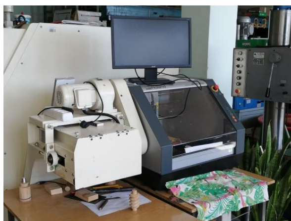
Рисунок 6 - Фрезерный станок с ЧПУ ROLAND -MDX-40A.
