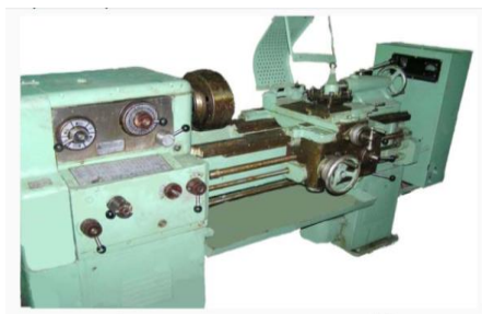
Рисунок 7 - Станок токарно-винторезный мод. 1М61.
