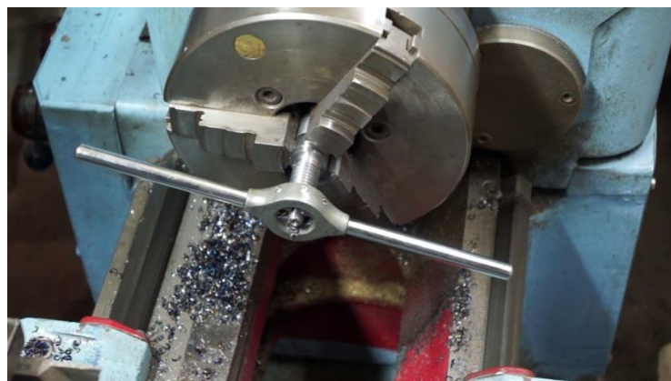
Рисунок 5 – Нарезание резьбы плашкой
