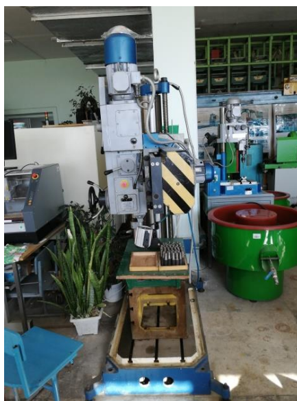
Рисунок 4 - Радиально-сверлильный станок модель – 2K522.
