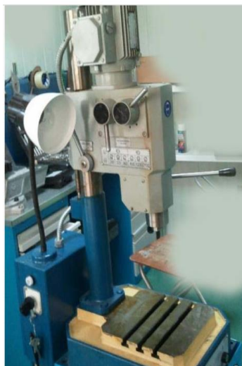
Рисунок 3 - Сверлильный станок модель - ГС 2116К.
