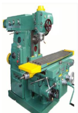
Рисунок 8 - Станок фрезерный широкоуниверсальный мод. 6P82 Ш.
