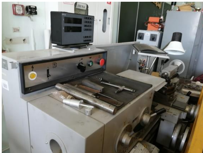
Рисунок 2 - Токарный станок 250 ИТВМ Φ1 с цифровой индикацией.
