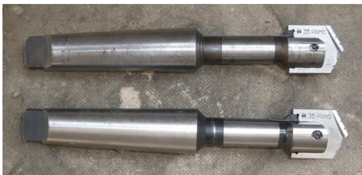
Рисунок 15 – Перовое сверло сборное
