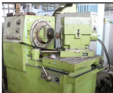
Рисунок 6 - зубострогальный полуавтомат модели 5П23БП.
