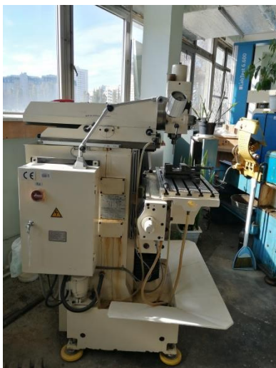
Рисунок 5 - Инструментальный фрезерный станок JTM-1230W3 DRO.
