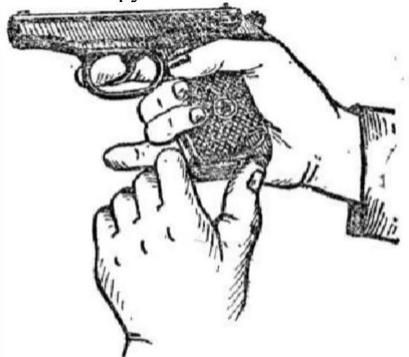
Рис. 3. Извлечение магазина из основания рукоятки
