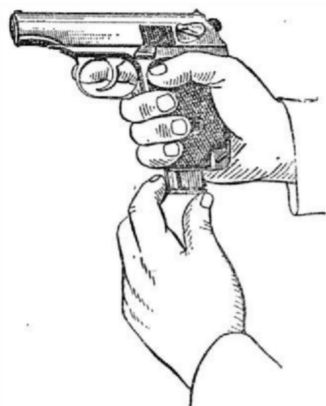
Рис. 8. Вставление магазина в основание рукоятки
