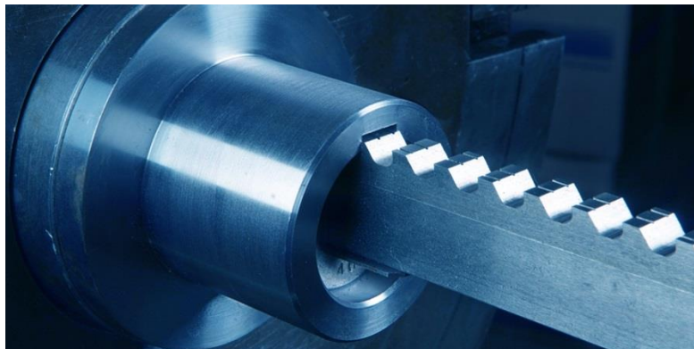
Рисунок 8 – Протягивание паза в детали
