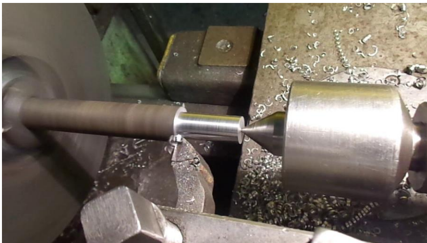
Рисунок 1 – Обработка заготовки токарным резцом
