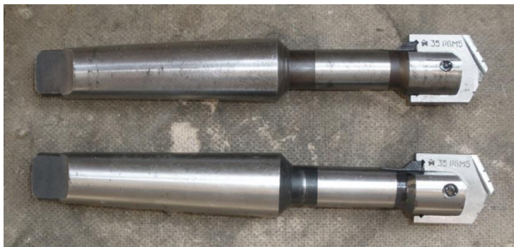
Рисунок 15 – Перовое сверло сборное
