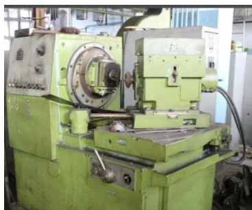
Рисунок 6 - зубострогальный полуавтомат модели 5П23БП.
