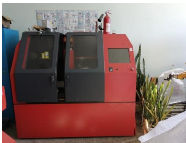
Рисунок 3 - Фрезерный станок с ЧПУ Роутер 6040S.
