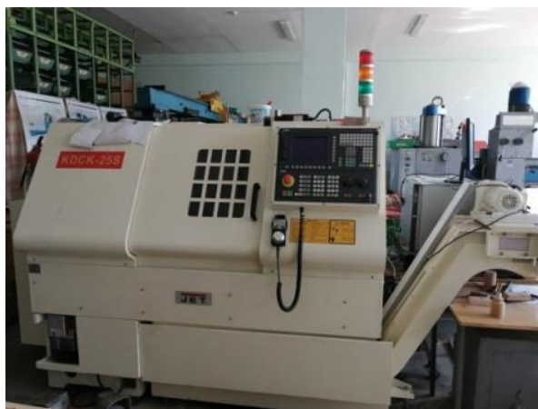
Рисунок 2 - Токарный станок JET с ЧПУ модели KDCK-25S CNC
