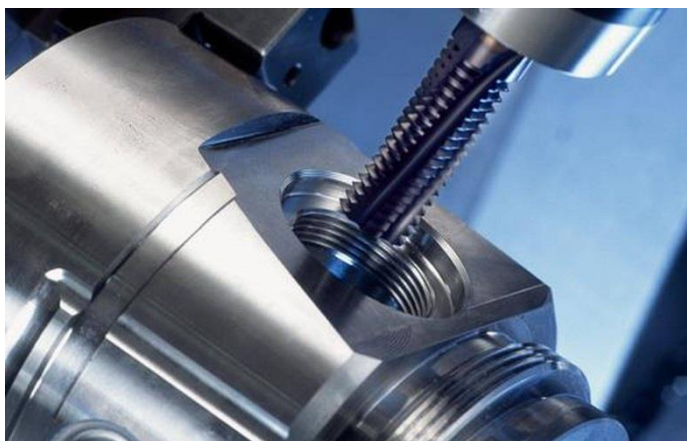
Рисунок 6 – Нарезание резьбы метчиком
