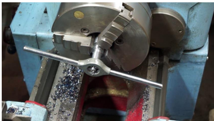
Рисунок 5 – Нарезание резьбы плашкой
