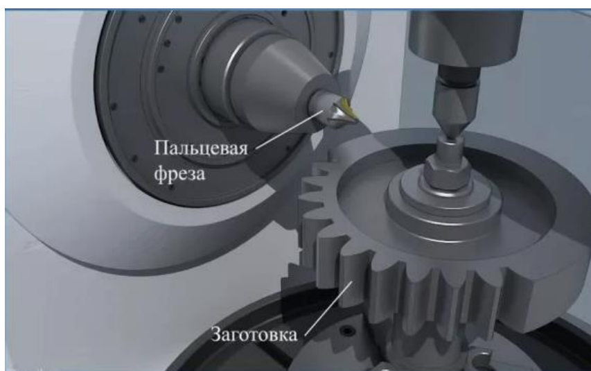
Рисунок 7 – Фрезерование зубчатых колес пальцевой фрезой
