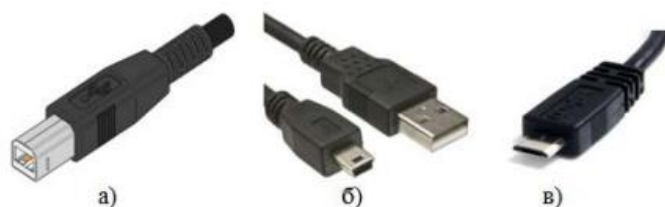
Рисунок 5 — Варианты USB-кабелей: а) USB type B для Arduino UNO и Mega; б) кабель для Arduino Nano; в) micro-USB для Arduino Mini
