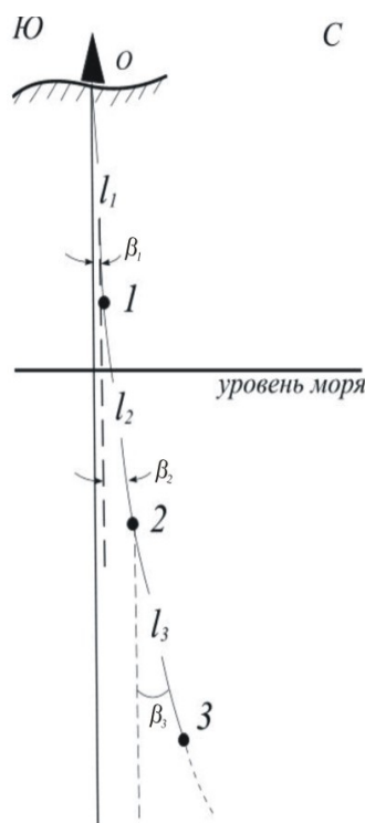
Рисунок 2.2 Построение вертикальной проекции скважины упрощённым способом
