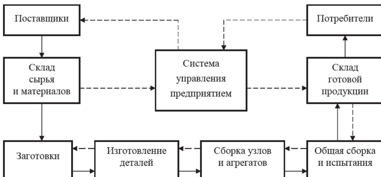
Рис. Схема вытягивающей системы управления
