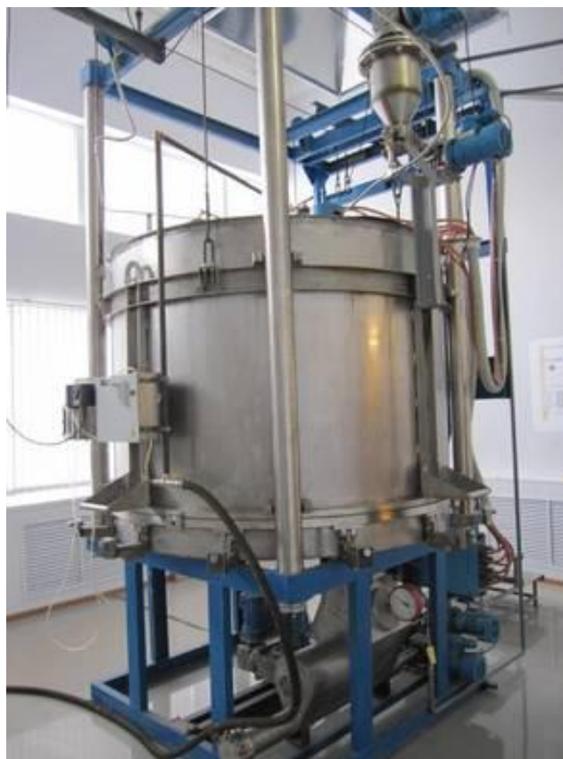
Рис. 6. Общий вид реактора для синтеза углеродных наноматериалов методом газофазного химического осаждения в процессе каталитического пиролиза углеводородов.
