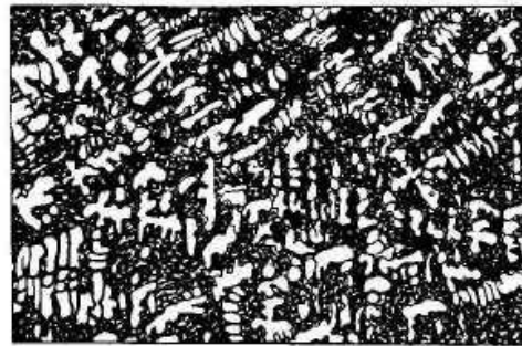
Рисунок 4. Влияние модифицирования на температуру эвтектического превращения, содержание кремния в эвтектике в сплавах Al-Si - а (сплошная линия – немодифицированные сплавы, штрих-пунктир – модифицированные) и микроструктура сплава AL2 с 13 %Si – б. X200
