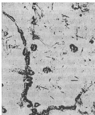
Рисунок 2. Микроструктура литой стали 110Г13Л (аустенит, карбиды). X200
