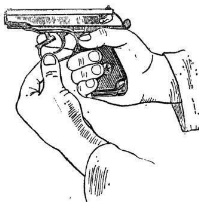
Рис. 4. Оттягивание спусковой скобы
