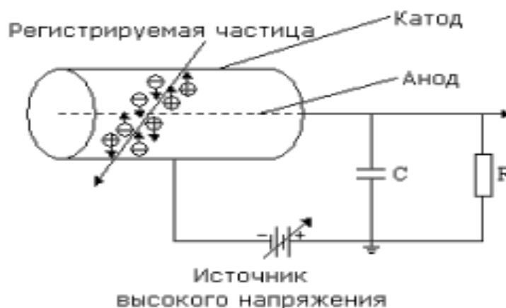
Рисунок 2. 4 – Принципиальная схема конструкции ГС
