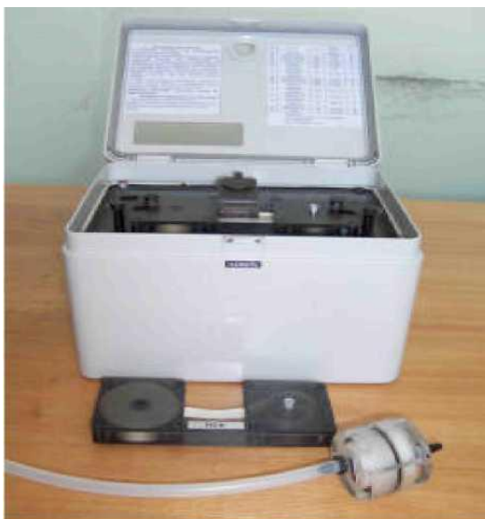
Рисунок 3.2 – Общий вид газоанализатора ГАНК-4
