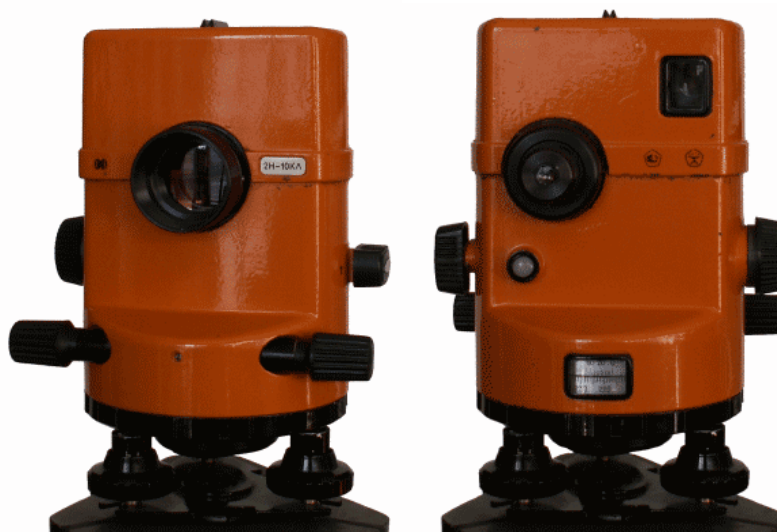
Рис. 6. Точный нивелир 3Н-3КЛ с компенсатором и лимбом: 1 – лимб; 2 – наводящий винт; 3 – кремальера; 4 – визир
