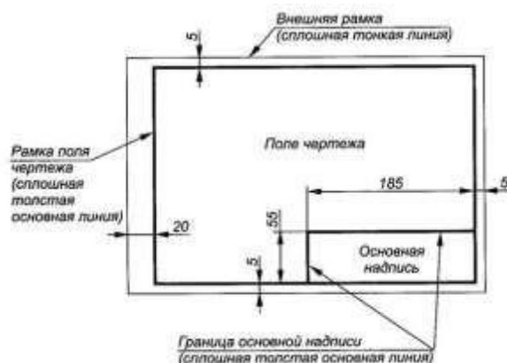
Рисунок 1.1 – Образование формата чертежа Таблица 1.1 – Основные форматы
