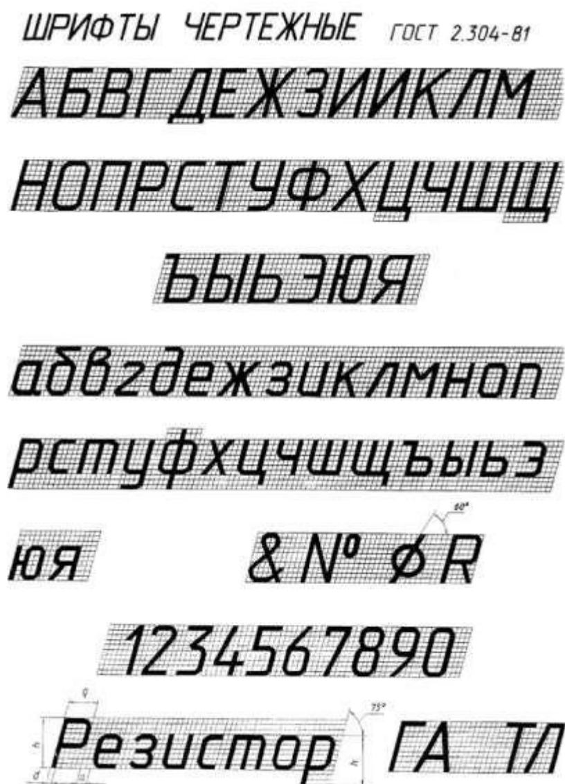
Рисунок 1.1 – Шрифт типа Б с наклоном 75°
