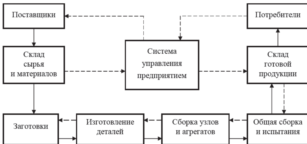
Рис. 3.2. Схема вытягивающей системы управления
