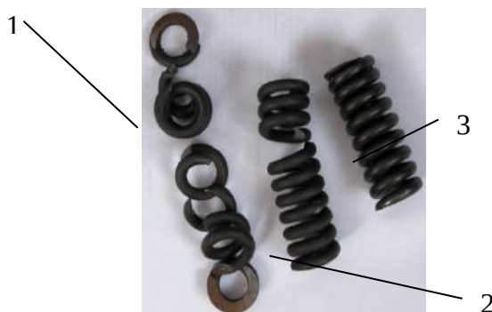
Рисунок 1 – Дефектные пружины гидрозамков подъёмника:
