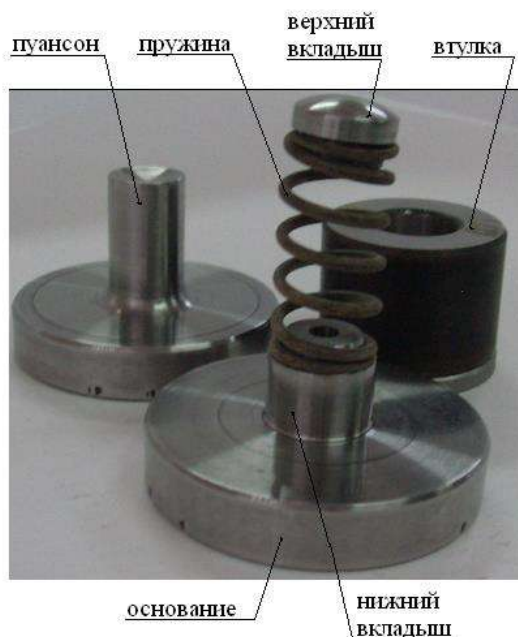
Рисунок 4 – Детали устройства для заневоливания внутренней пружины клапана двигателя автомобилей семейства ВАЗ
