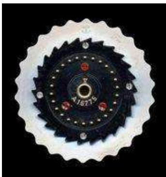
Рис. 3.4. Правая сторона ротора, видны штыревые контакты
