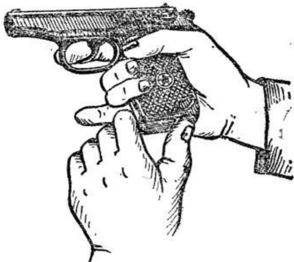
Рис. 3. Извлечение магазина из основания рукоятки
