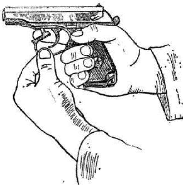
Рис. 4. Оттягивание спусковой скобы
