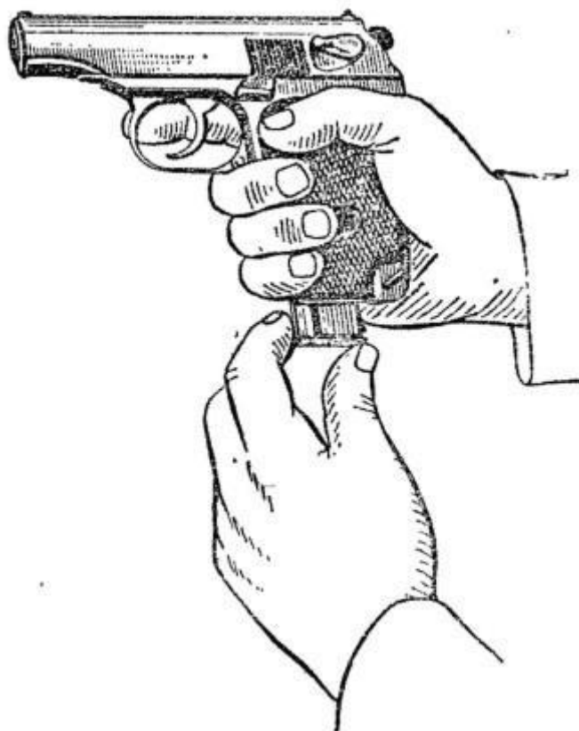
Рис. 8. Вставление магазина в основание рукоятки
