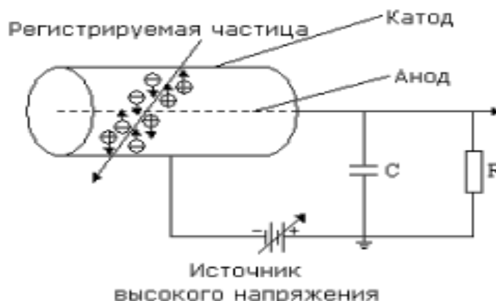
Рисунок 2. 4 – Принципиальная схема конструкции ГС
