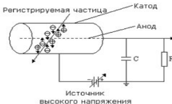
Рисунок 2. 4 – Принципиальная схема конструкции ГС
