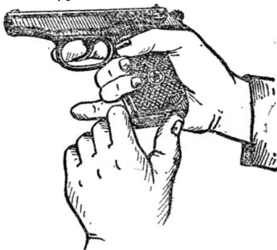
Рис. 3. Извлечение магазина из основания рукоятки
