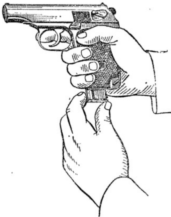
Рис. 8. Вставление магазина в основание рукоятки
