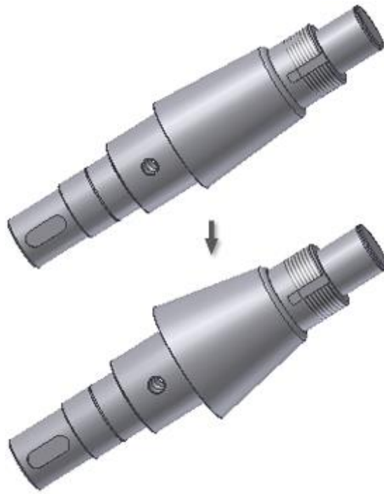
Рисунок 10.23. Результат редактирования конуса вала
