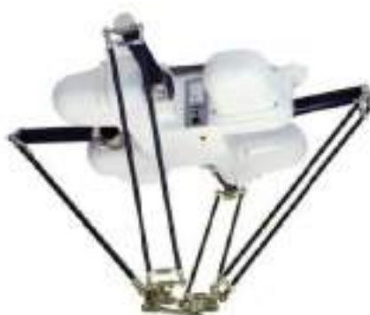
Рисунок 3 – Параллельный робот (дельта-робот)
