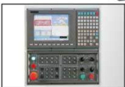
Контроллер с кодами GM схожий с Fanuc
